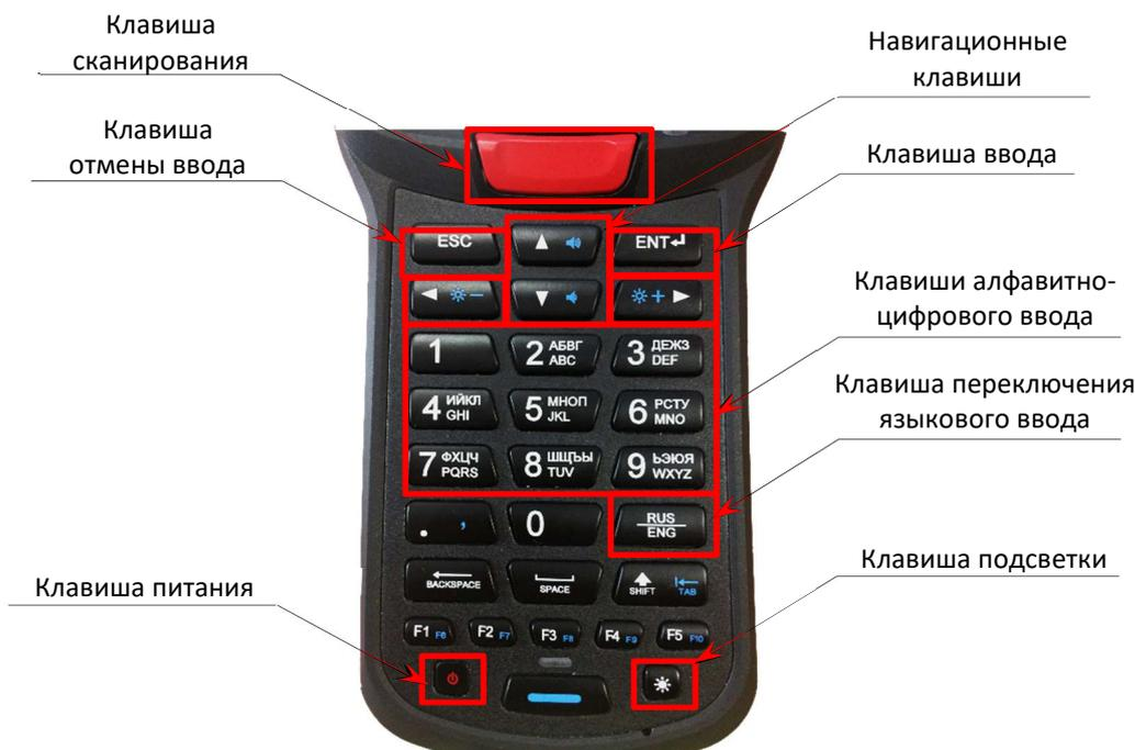
Рисунок 10. Клавиатура устройства (основные клавиши)
